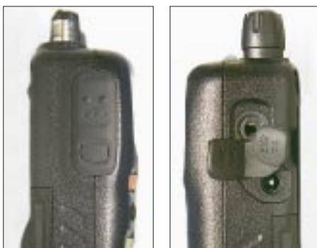
Die unter der Sendetaste liegende Tonruftaste schaltet zugleich den Sender. Auf der rechten Seite finden sich außer der Antennenbuchse alle übrigen Anschlüsse.
