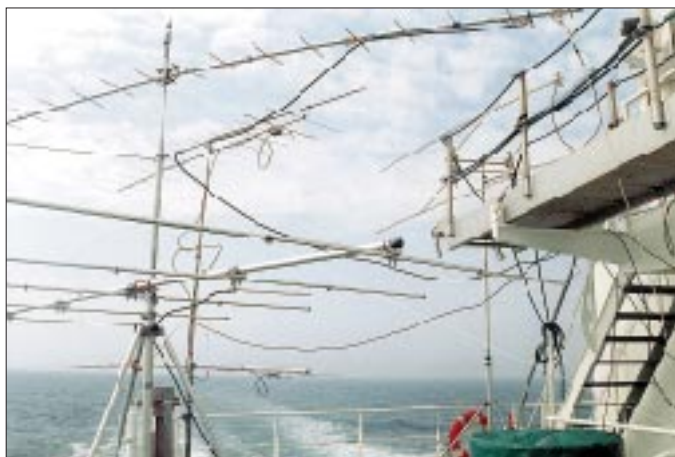
Wo man hinsah, überall Antennen: 2 x 13-Ele.-Yagis für 2 m, 5-Ele.-Yagi für 6 m, 21-Ele.-Yagi für 70 cm sowie 4 x 67-Ele.Yagis für 23 cm.
